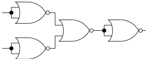
XOR 回路  $A \oplus B = A \cdot \overline{B} + \overline{A} \cdot B = \overline{\overline{\overline{A \cdot \overline{B} + \overline{A} \cdot B}}} = \overline{(A \cdot \overline{B}) \downarrow (\overline{A} \cdot B)}$
